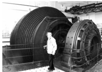
Maquinària del cable de la torre Maria Teresa a les mines de sal
